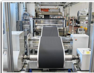
◀ **Beschichtung: Über dutzende Rollen werden die Metallfolien mit dem dunklen Trägerstoff beschichtet und anschließend getrocknet. Die Bänder legen eine Geschwindigkeit von bis zu 200 Meter pro Minute zurück.**
